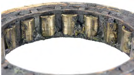
Lagerschaden infolge einer Fettschädigung Bearing damage due to grease degradation
