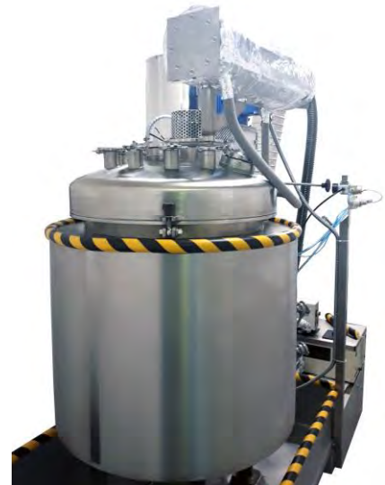
Apparat zur Herstellung von künstlich gealterten Schmierölen, 25°C - 300°C, bis 200 Liter / Device for the production of artificial altered lubricants, 25°C - 300°C, up to 200 litres
