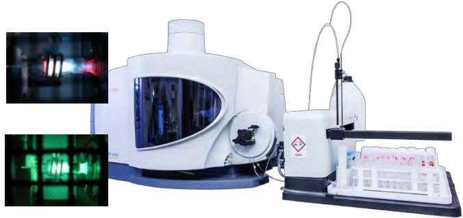
Atomemissionsspektrometer; Analysekammer mit Plasmafackel (betrieben mit unterschiedlichen Versuchsmusterlösungen) / ICP-OES; Analysis Chamber with Plasma Torch (operated with different sample solutions)
