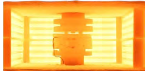
Ring-Reibungs- und Verschleiß-Tribometer mit Hochtemperatur-Testzelle High Temperature Chamber of Ring-Friction-and-Wear Tribometer
